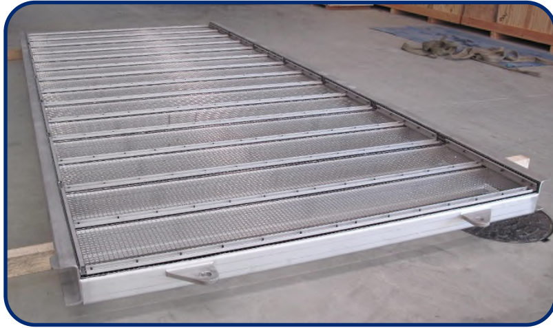
Panneau filtrant statique assemblé en atelier
